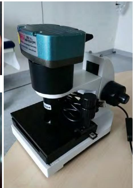
Abb. 2: Kapillarmikroskop
